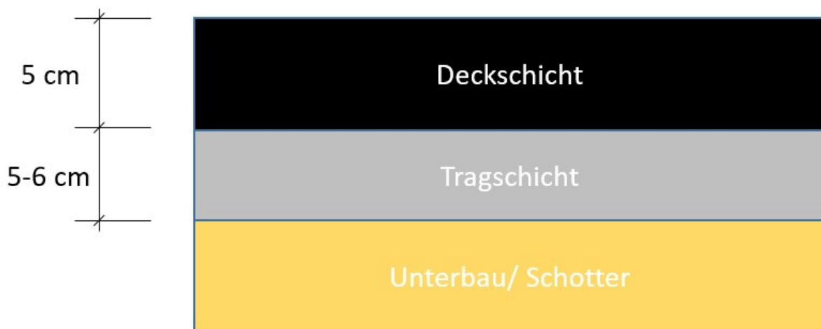
Abbildung 29: Belagsaufbau
